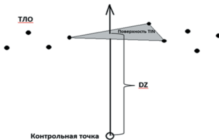
Рисунок 3 — Оценка разности высот между контрольными точками и поверхностью TIN-модели
