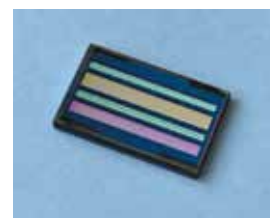
Рисунок 1 — Пример изготовленного четырёхзонного светофильтра
