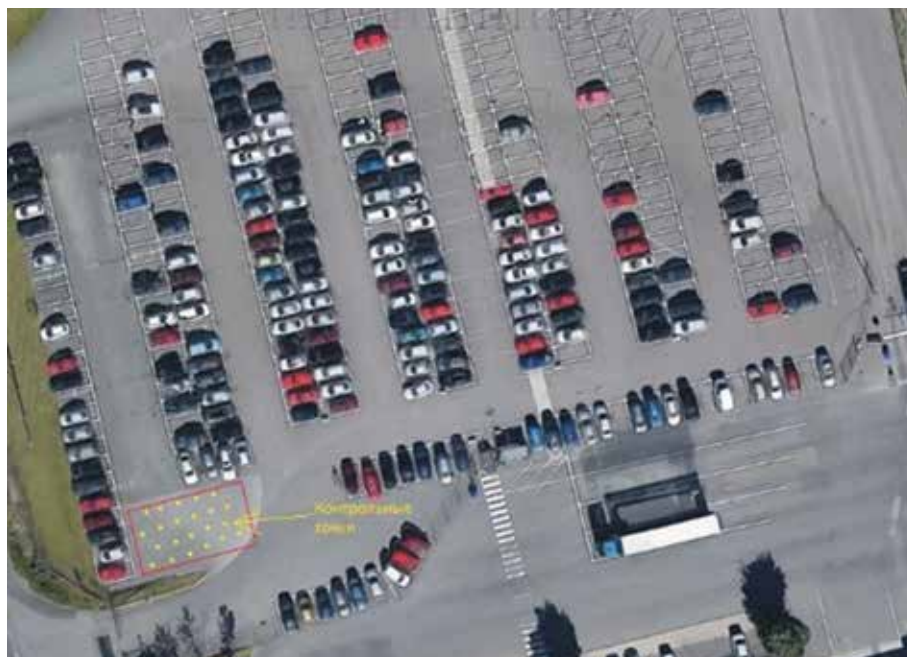
Рисунок 1 — Пример расположения контрольных точек для оценки точности ТЛО по высоте
