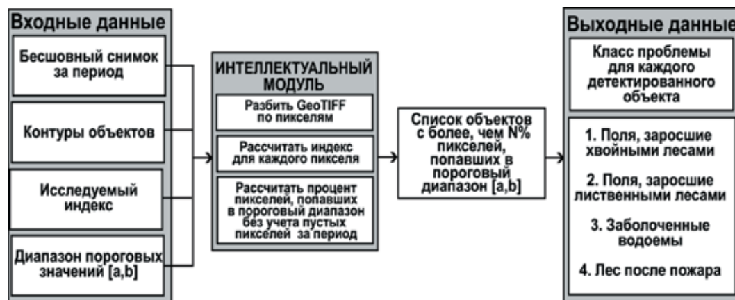
Рисунок 1 — Общая структура модуля детекции проблемных объектов природопользования и определения пороговых значений
