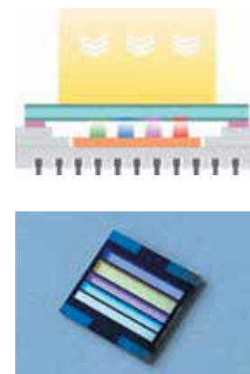
Рисунок 3 — Пример изготовленного пятизонного светофильтра
