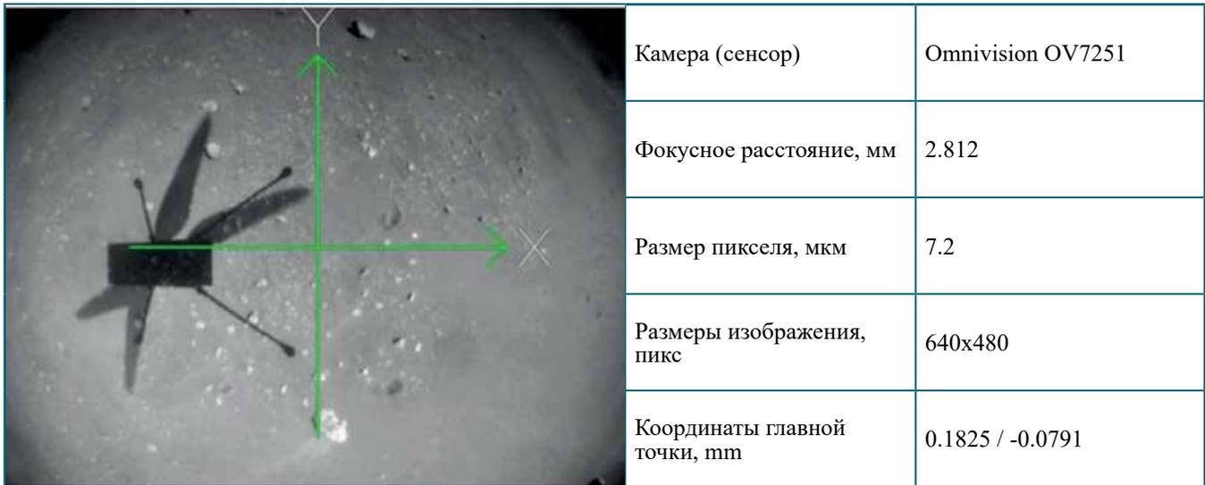
Рисунок 1 — Пример изображения, переданного Ingenuity и определенные параметры камеры
