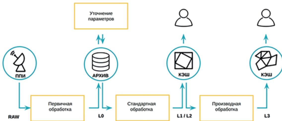
Рисунок 1 — Общая схема потоков данных и этапов обработки при формировании ортомозаик
